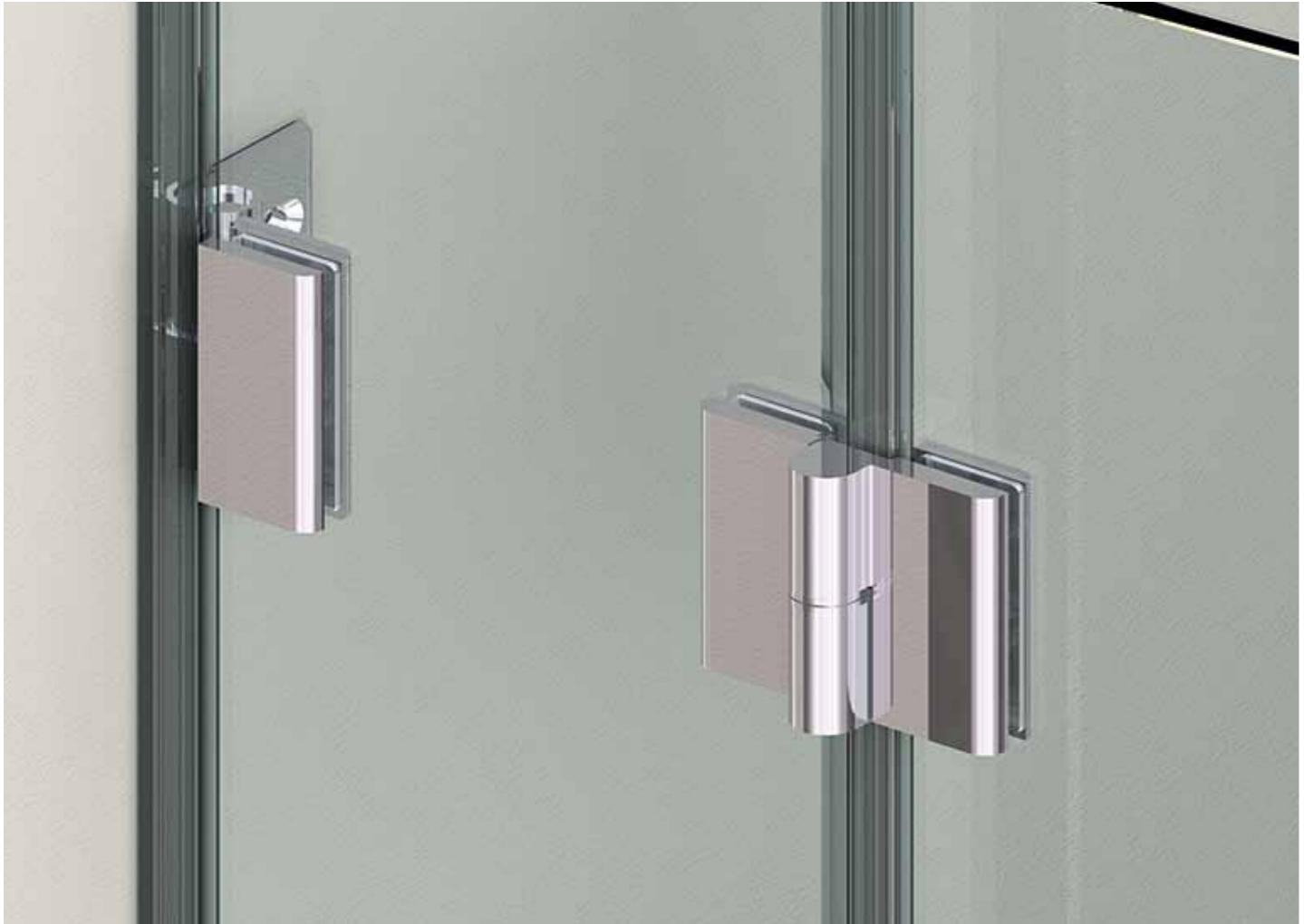
Cerniere vetro-vetro e vetro muro per box doccia, con alzata in apertura. Le dimensioni minime, la grande leggerezza, ne fanno una cerniera particolarmente apprezzata. Il meccanismo permette la chiusura dell'anta con impacchettamento a 180°. Il sistema di alzata abbinato ad una guarnizione specifica, rende ermetica l'applicazione.
